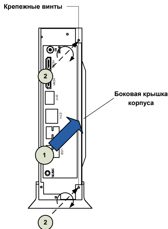
Рисунок 7 - Монтаж крышки корпуса
