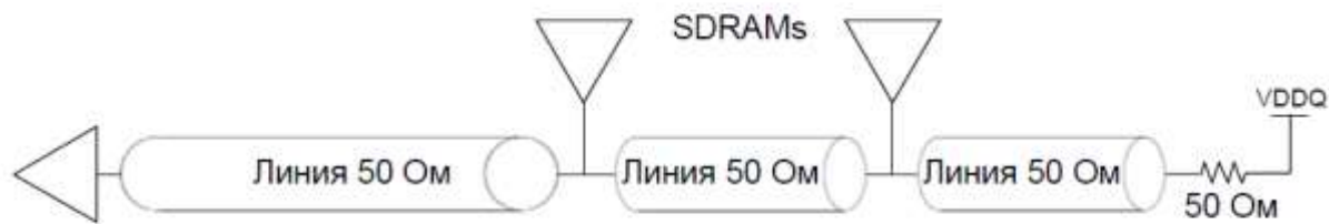
Рисунок 7.10 - Схема подключения сигналов MCj_ALERT_N в случае размещения микросхем памяти на материнской плате
