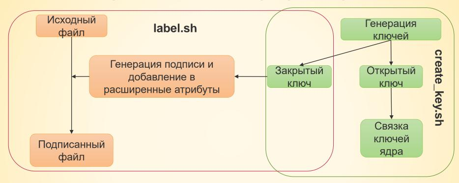
Скрипт create\_key.sh evm { rsa | rsa\_encrypted| LMK\_encrypted } осуществляет создание закрытого и открытого ключей RSA и добавление открытого ключа в связку ключей ядра для осуществления последующей проверки вычисленных подписей.
